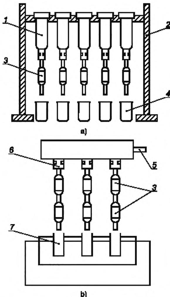
а) устройство для нанесения ДНФГ, б) устройство для сушки картриджей; 1 — стеклянный шприц вместимостью 10 мл; 2 — стойка для шприцев; 3 — картриджи; 4 — стакан для слива, 5 — лоток газообразного  $N_2$ ; 6 — штуцер для шприцев; 7 — стаканчик для отходов
