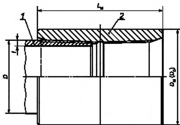
1 — труба; 2 — муфта;  $D$  — наружный диаметр трубы;  $D_m$  — наружный диаметр обычной муфты;  $D_m$  — наружный диаметр специальной муфты;  $L_m$  — длина муфты;  $t$  — толщина стенки трубы
