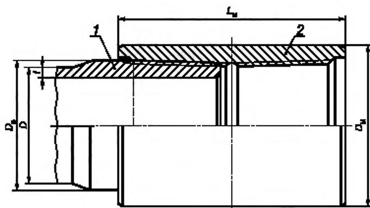
1 — труба; 2 — муфта;  $D$  — наружный диаметр трубы;  $D_n$  — наружный диаметр высаженного конца трубы;  $D_m$  — наружный диаметр муфты;  $L_m$  — длина муфты;  $t$  — толщина стенки трубы
