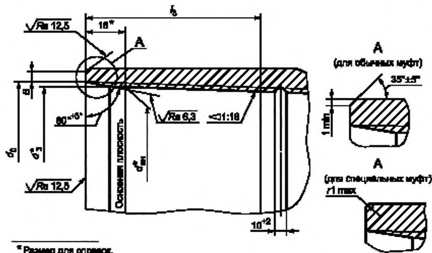
$B$  — ширина торцевой плоскости обычной муфты;  $d_{\text{вн}}$  — внутренний диаметр резьбы в основной плоскости;  $d_0$  — диаметр фаски в плоскости торца муфты;  $d_{\text{в}}$  — внутренний диаметр резьбы в плоскости торца муфты;  $l_3$  — длина резьбы с полным профилем муфты;  $r$  — радиус скругления кромки торца специальной муфты
