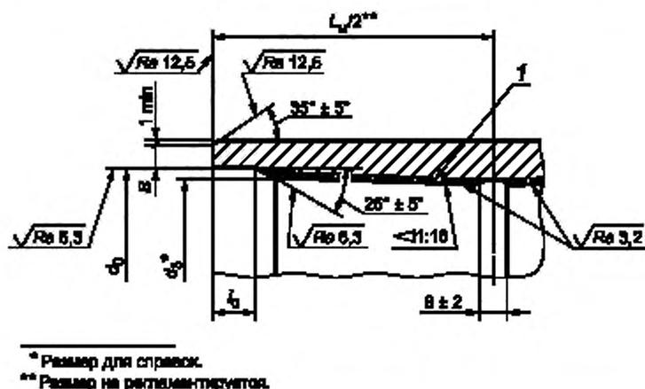
1 — линия среднего диаметра резьбы;  $B$  — ширина торцевой плоскости муфты;  $d_0$  — диаметр цилиндрической расточки муфты;
