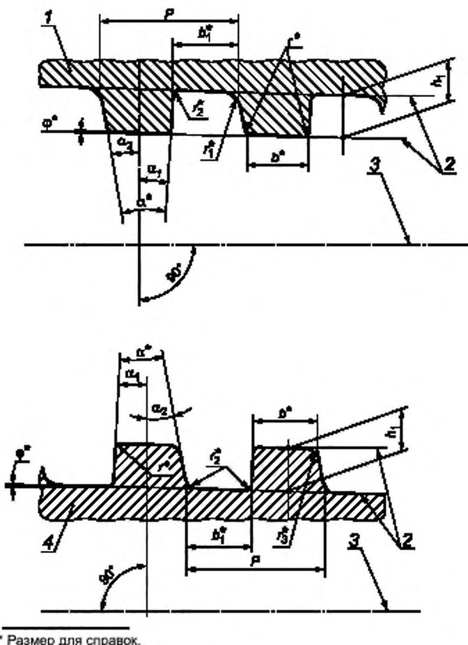
1 — профиль резьбы муфты; 2 — линии, параллельные образующей конуса резьбы; 3 — ось резьбы; 4 — профиль резьбы трубы;  $\alpha$  — угол профиля;  $\alpha_1, \alpha_2$  — углы наклона сторон профиля;  $b$  — ширина вершины профиля;  $b_1$  — ширина впадины профиля;  $\varphi$  — угол уклона резьбы;  $h_1$  — высота профиля;  $P$  — шаг резьбы;  $r, r_1, r_2, r_3$  — радиусы скругления профиля
