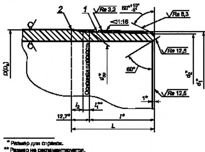
1 — линия среднего диаметра резьбы; 2 — конец сбега резьбы;  $D$  — наружный диаметр трубы;
