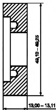
Материал — специальная модифицированная сталь AISI 8720 твердостью 58—62 HRC по шкале С Роквелла, с чистой обработкой поверхности 0,56—0,71 мкм (22—28 микродюймов).
