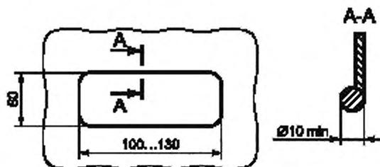
Рисунок 7 — Рекомендуемые размеры отверстий для хвата рукой
