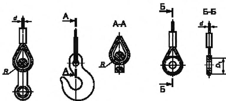
Рисунок 5 — Петли канатных ветвей, входящих в состав ГЗП
