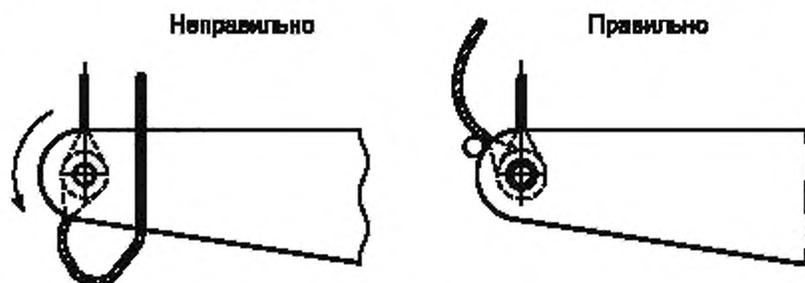
Рисунок 8 — Устройства, исключающие образование петель и перекруток
