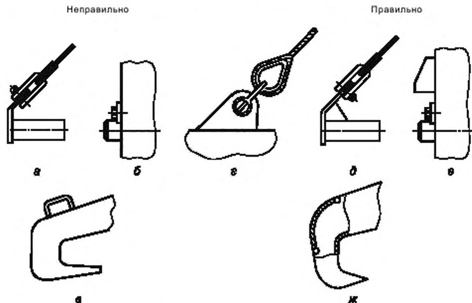
Рисунок 3 — Расположение и конструкция проушин на элементах ГЗП
