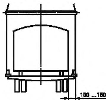
Рисунок 1 — Выступление наружных элементов траверс за контуры груза
