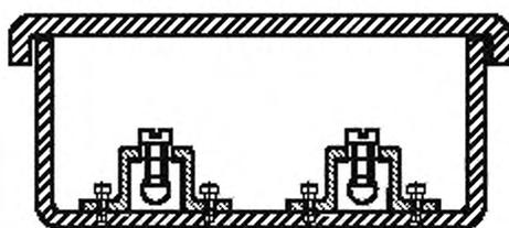
б — со вставленными выводами или соединительными устройствами
