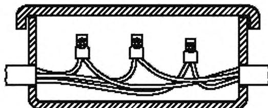
д — с плавающими оконечными или соединительными устройствами
