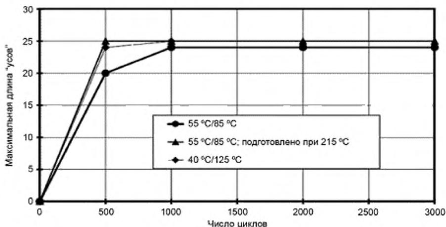
Рисунок Н.4 — Рост усов на медно-основных выводах (QFP) в испытании на термоциклирование
