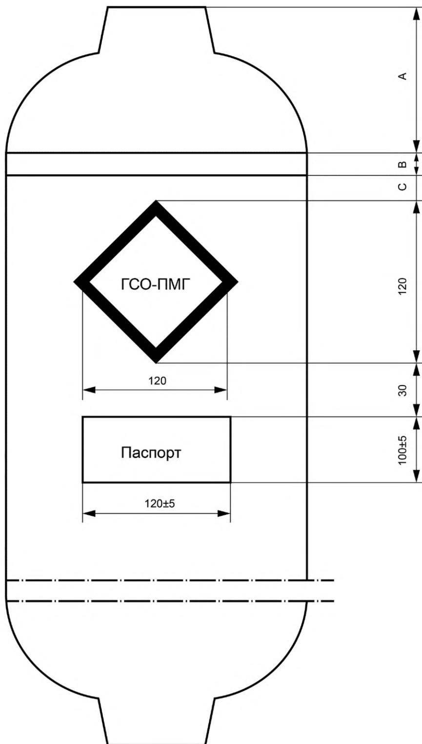
Рисунок В.1 — Маркировка баллона
