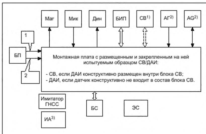
Mag – аудиосистема ТС; Мик – микрофон; Дин – динамик; БИП – блок интерфейса пользователя СВ; ДАИ – блок датчика аварии; АГ – антенна ГНСС; АГ – антенна GSM/UMTS; БП – блок питания (12/24 В); БС – блок сопряжения; ЭС – эмулятор системы экстренного реагирования при авариях; ИА – имитатор аварии; 1 – кабель питания; 2 – цепь зажигания
