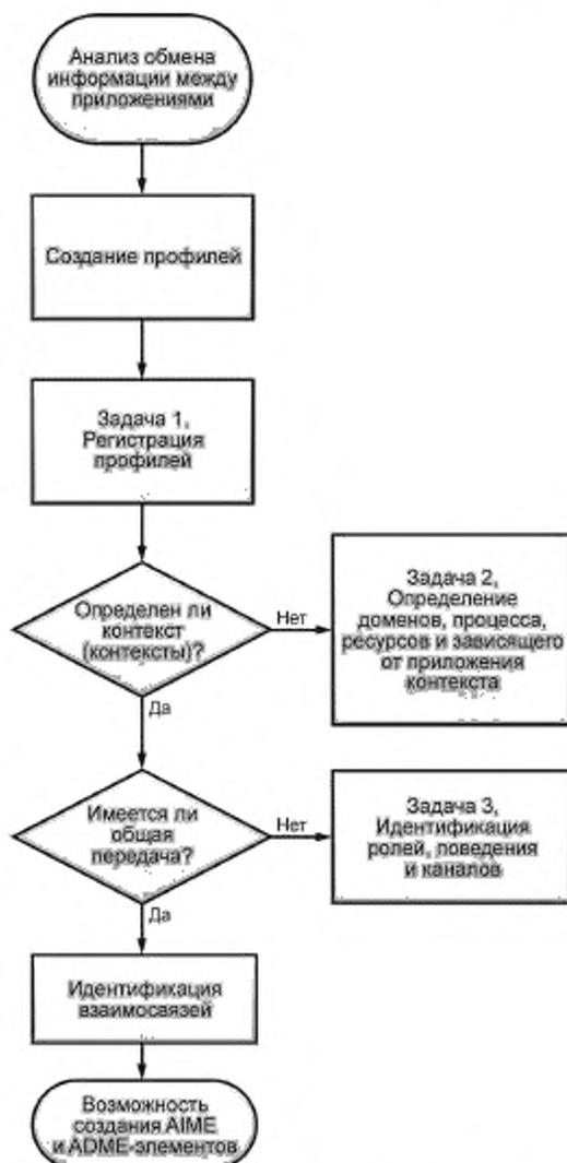
Рисунок 10 — Диаграмма, иллюстрирующая процедуру формирования AIME- и ADME-элементов
