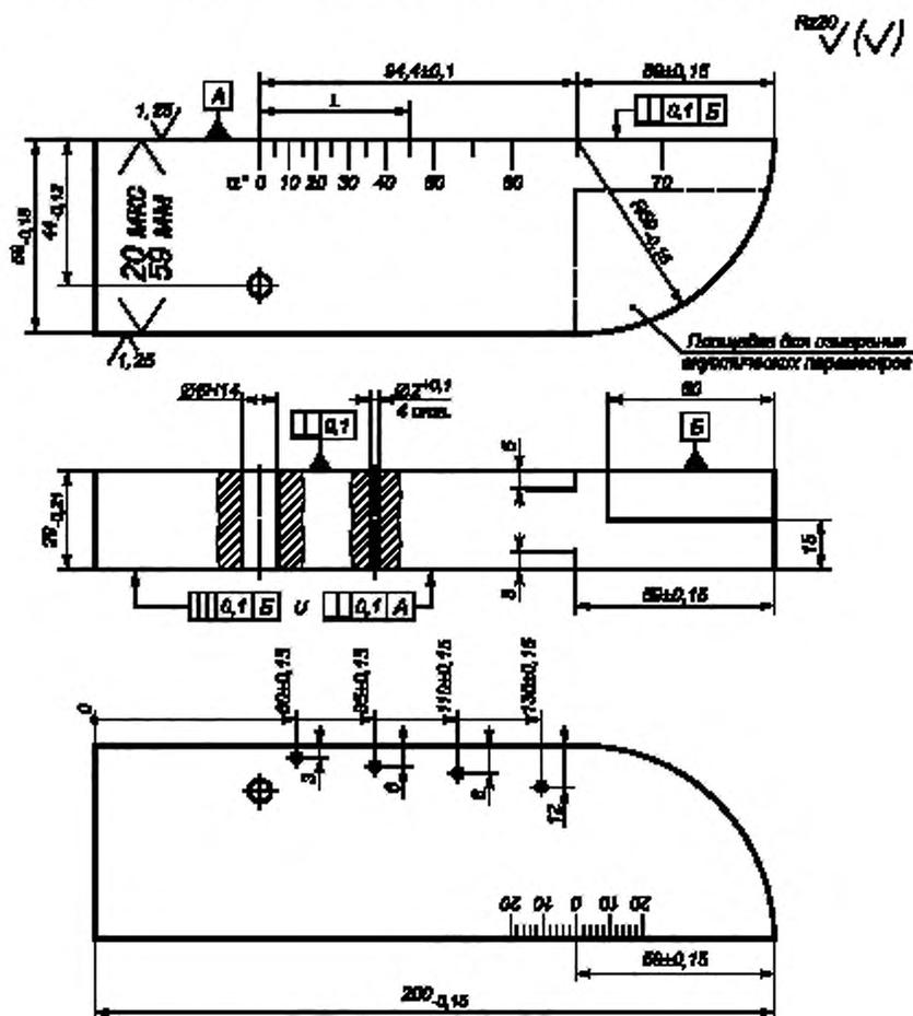
Рисунок 4 — Стандартный образец СО-3Р
