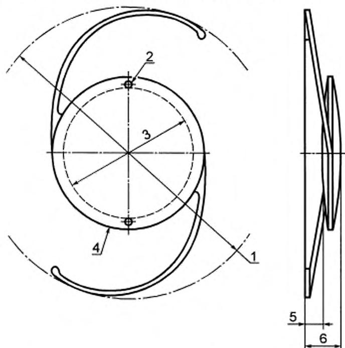
1 — общий диаметр; 2 — позиционное отверстие; 3 — оптическая часть; 4 — тело; 5 — высота свода; 6 — сакциаль
