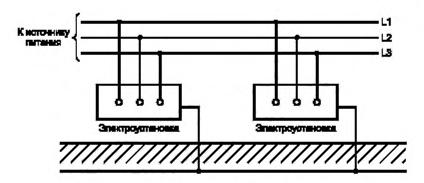
01-10-10 заземление на землю: Формирование замкнутой цепи для отвода аномально высокого напряжения и опасных блуждающих и иных токов непосредственно в окружающую токопроводящую конструкцию, электролитическую среду.
