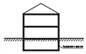
01-10-08 заглубленный в грунт фундаментный заземлитель (soil-embedded foundation earth electrode): Заземляющий электрод, как правило, в виде замкнутого контура, заглубленный в грунт под фундаментом здания [МЭК 60050-826:2004, статья 826-13-08, Изм., ГОСТ Р 50571.5.54—2013/МЭК 60364-5-54:2011], [I].
