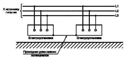
01-10-32 земля: Обобщающее эквивалентное определение электролитической среды, окружающей токопроводящую конструкцию. 01-10-33 (ближняя) земля ((local) earth (local) ground (US)): Часть земли, которая находится в электрическом контакте с заземлителем и электрический потенциал которой не равен нулю.
