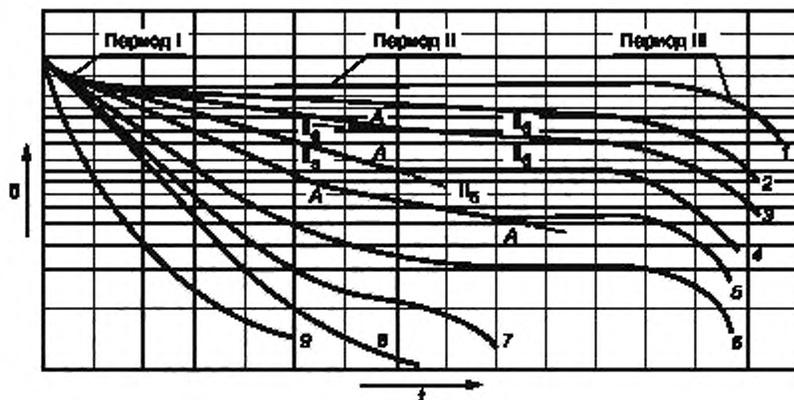
Рисунок 1 — Типовые кривые релаксации в координатах «напряжение — время»
