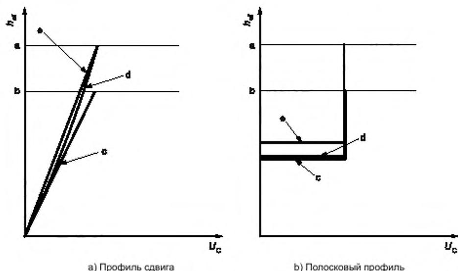
$h_{st}$  — высота над морским дном,  $U_c$  — скорость течения;  $a$  — гребень волны;  $b$  — уровень застойной зоны потока;  $c$  — профиль входного течения,  $d$  — нелинейный растянутый профиль течения;  $e$  — линейный растянутый профиль течения
