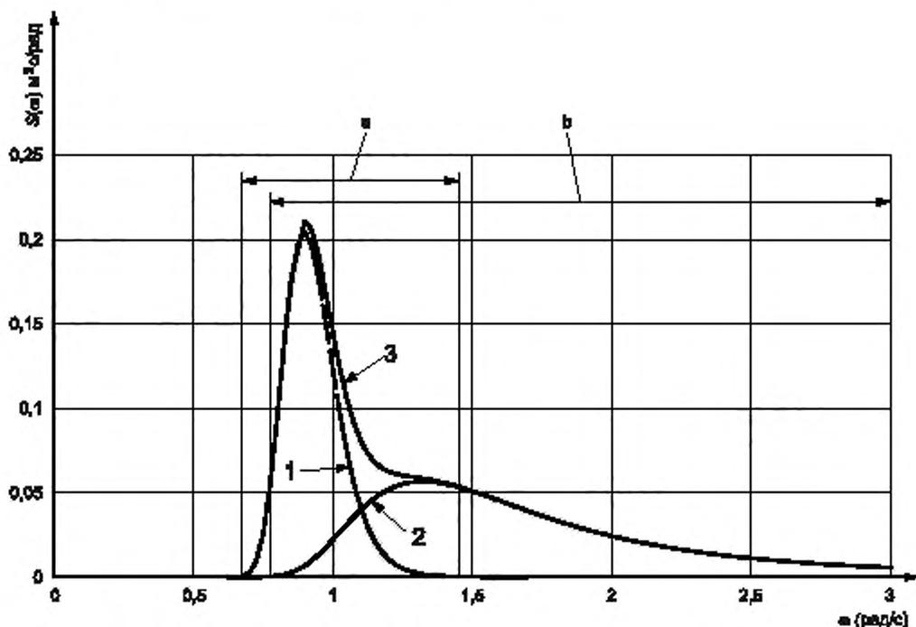
$\omega$  — частота;  $S(\omega)$  — спектр; 1 — спектр зыби; 2 — спектр ветровых волн; 3 — полный спектр, а — диапазон частот спектра зыби; б — диапазон частот спектра ветровых волн
