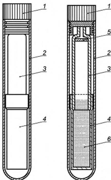
1 — колпачок; 2 — предохранительная трубка; 3 — трубка для элюирования; 4 — диффузионный фильтр; 5 — фритта;
