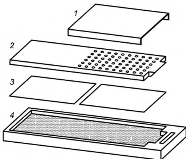
1 — скользящая крышка; 2 — диффузионный экран; 3 — фильтры, пропитанные ДНФГ; 4 — корпус пробоотборного устройства
