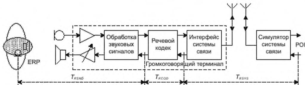
Рисунок 7 — Задержка распространения сигнала в направлении приема
