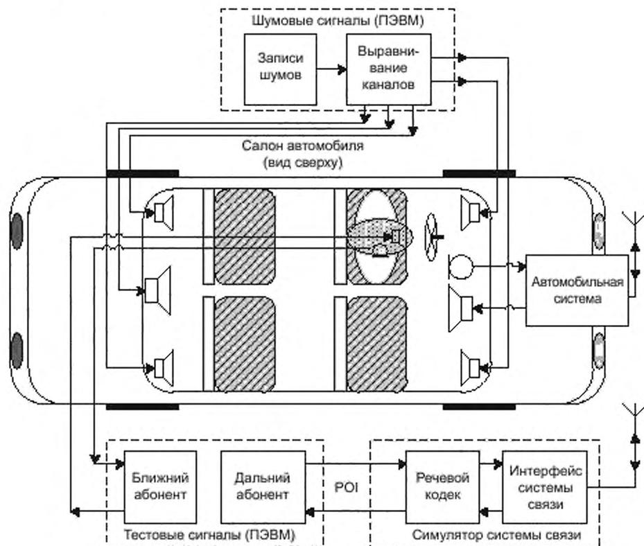
Рисунок 3 — Тестовое оборудование для имитации внешнего акустического шума
