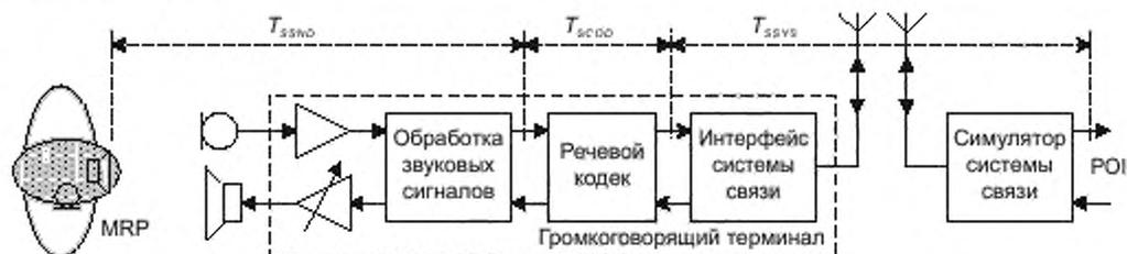
Рисунок 6 — Задержка распространения сигнала в канале передачи
