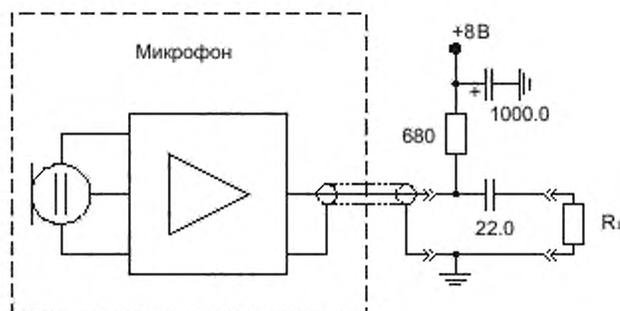
Рисунок 2 — Блок-схема испытательной установки для микрофонов
