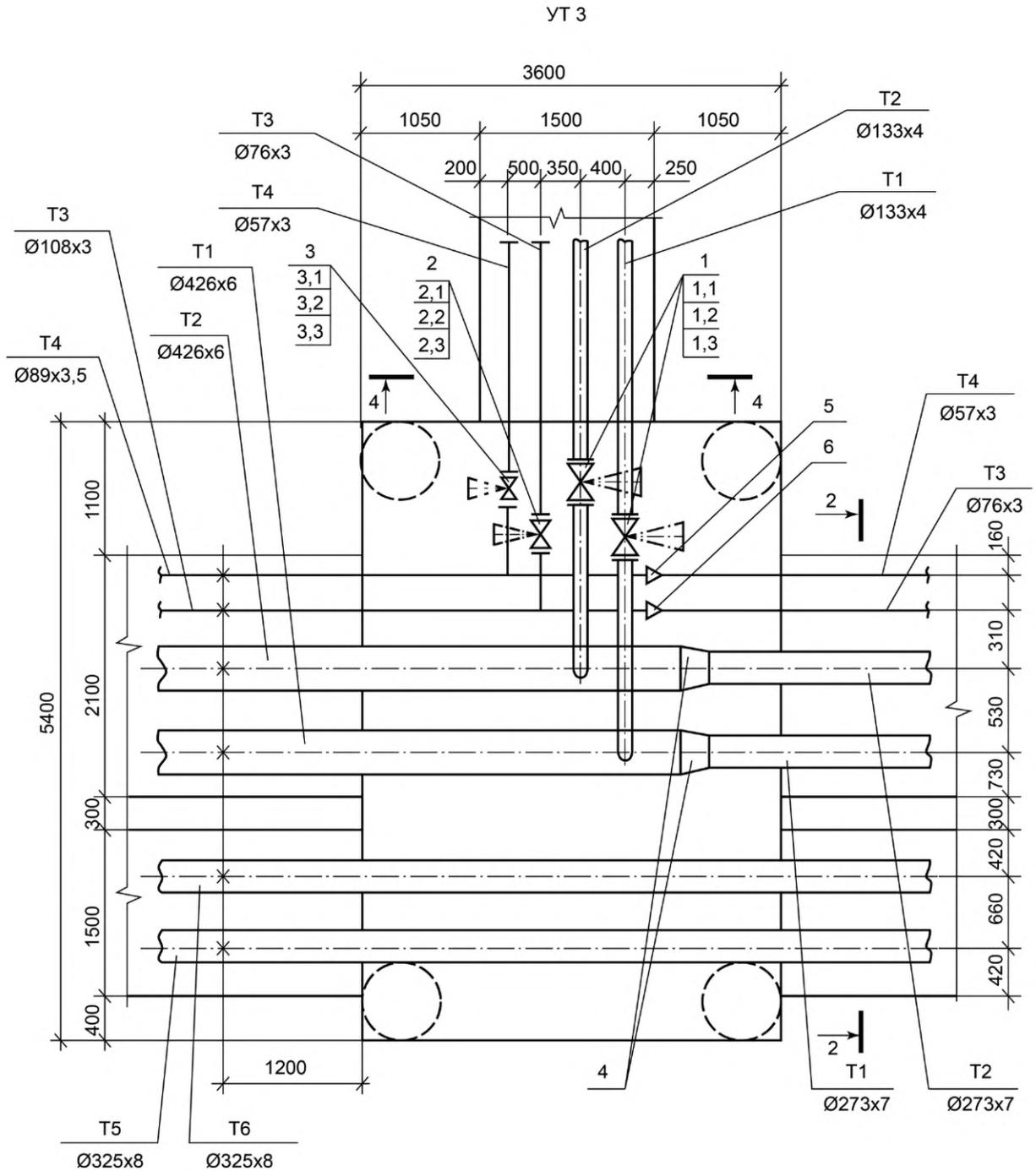
Рисунок Е.1 — План узла трубопровода при подземной канальной прокладке
