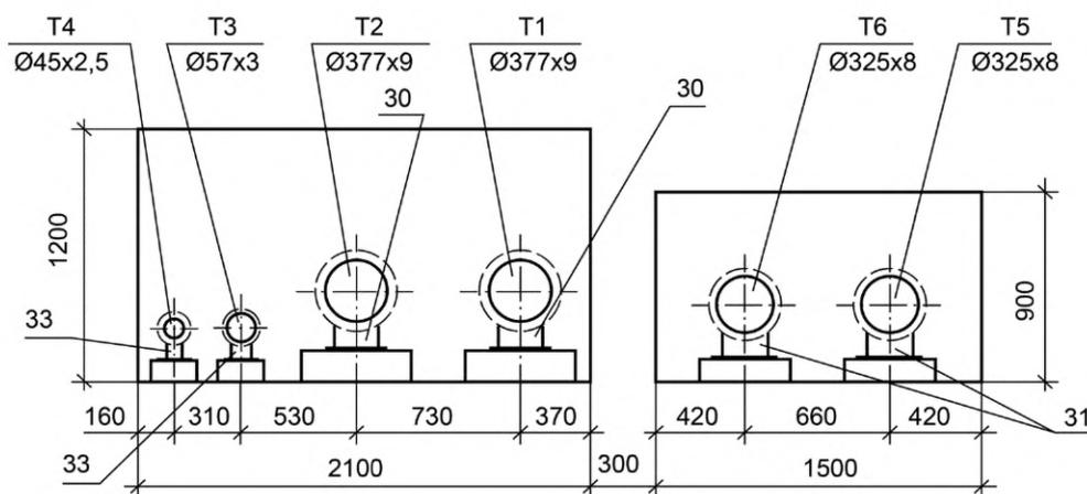
Рисунок Г.1 — Поперечный разрез при подземной прокладке
