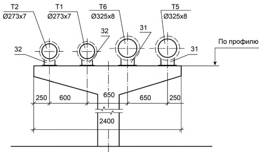
Рисунок Г.2 — Поперечный разрез при надземной прокладке
