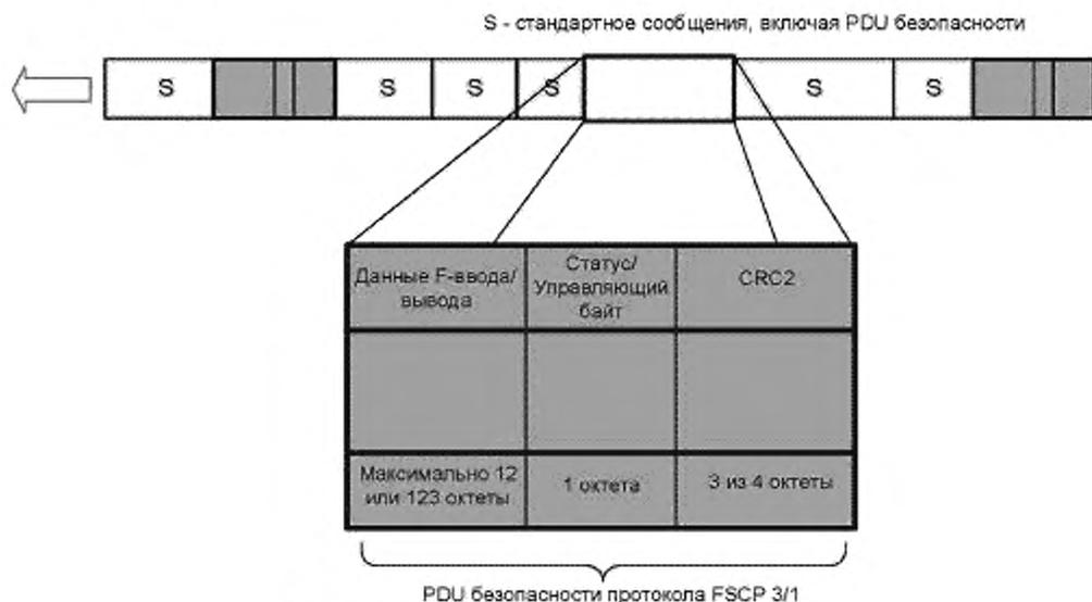
Рисунок 4 — Структура PDU безопасности FSCP 3/1
