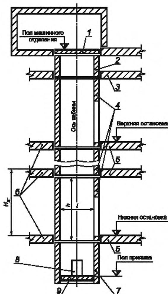
1 — плита перекрытия над шахтой лифта; 2 — верхний блок; 3 — чердачное перекрытие; 4 — средние блоки; 5 — лестничные площадки; 6 — междуэтажные перекрытия; 7 — нижний блок; 8 — тумба под буфер кабины; 9 — плита пола приямка;  $H_{эт}$  — высота этажа здания
