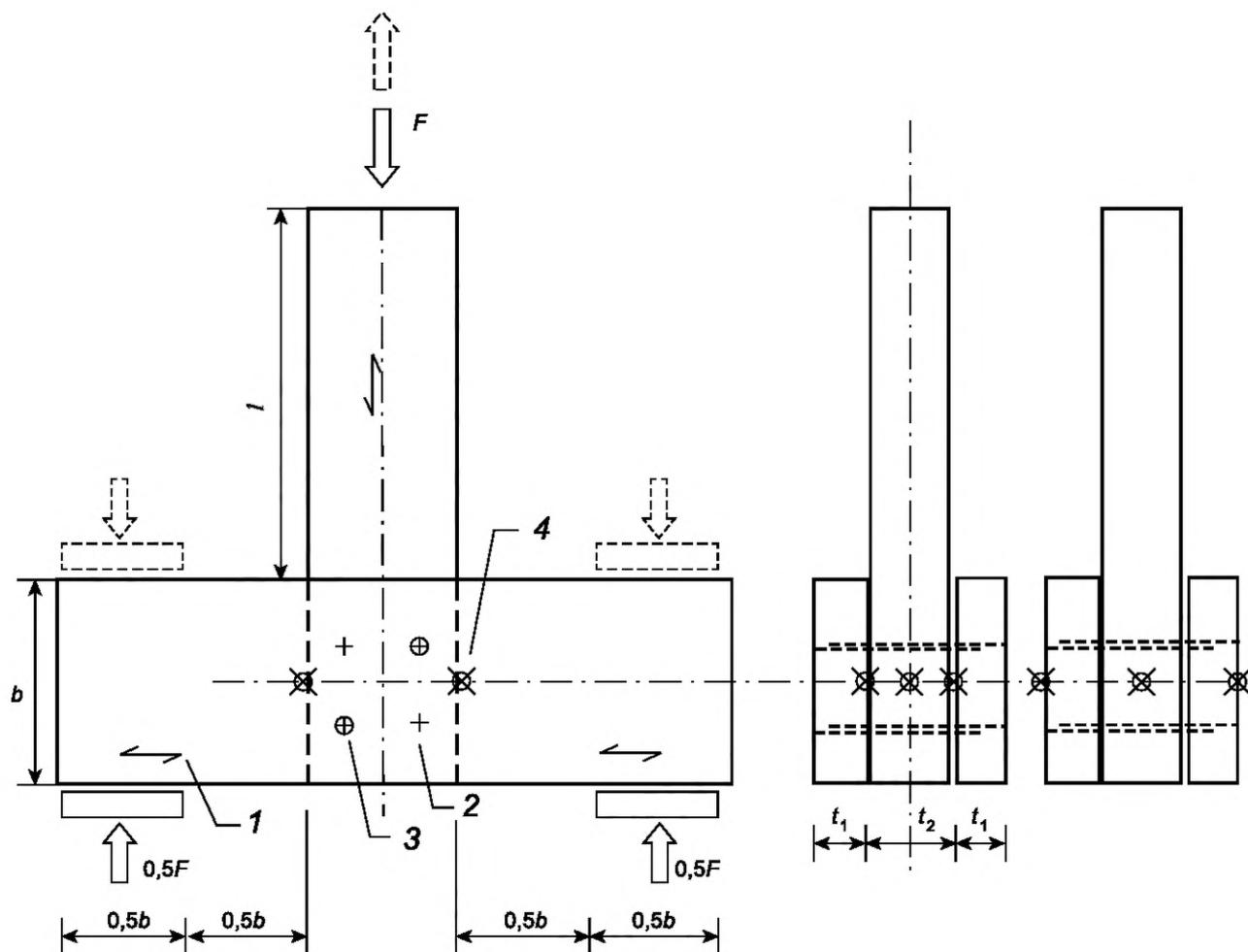
1 — направление волокон; 2 — невыступающая часть крепежа; 3 — выступающая часть крепежа; 4 —  $\oplus$  точки измерения смещений;  $l$  — смещение элементов;  $t_1$  — ширина крайнего элемента;  $t_2$  — ширина среднего элемента
