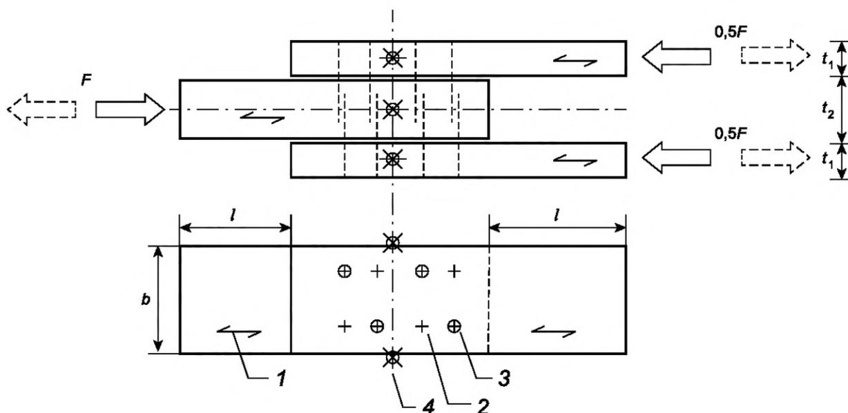
1 — направление волокон; 2 — невыступающая часть крепежа; 3 — выступающая часть крепежа; 4 —  $\oplus$  точки измерения смещений;  $l$  — смещение элементов;  $t_1$  — ширина крайнего элемента;  $t_2$  — ширина среднего элемента
