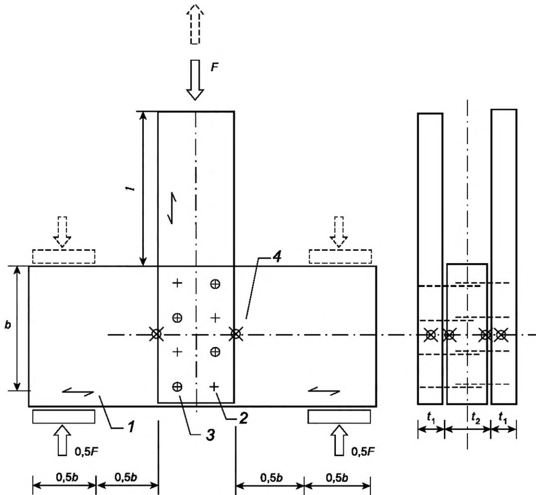
1 — направление волокон; 2 — невыступающая часть крепежа; 3 — выступающая часть крепежа; 4 —  $\oplus$  точки измерения смещений;  $l$  — смещение элементов;  $t_1$  — ширина крайнего элемента;  $t_2$  — ширина среднего элемента
