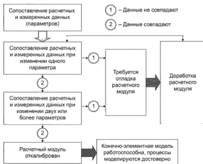
Рисунок 3 — Рекомендуемая блок-схема алгоритма калибровки КЭ модели
