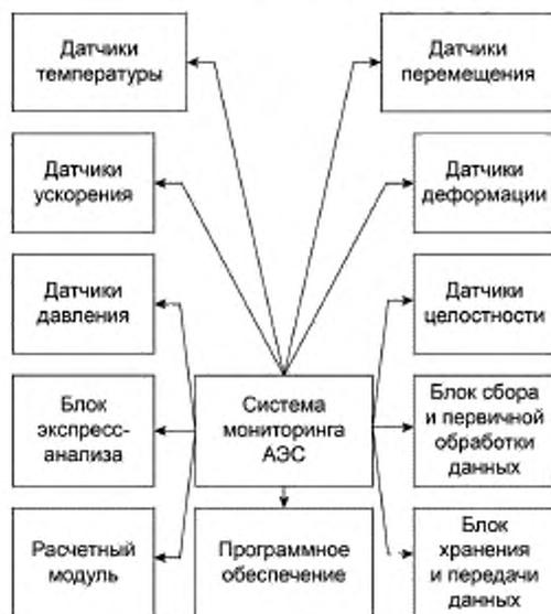
Рисунок 1 — Схема структурного состава СМНЭП
