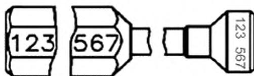
Рисунок Б.5 — Пример разрушения ЭПУ стержневого типа
