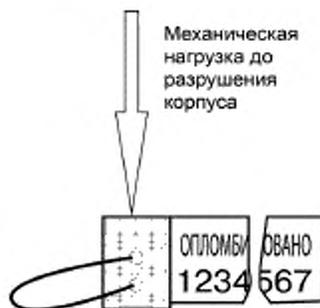
Рисунок Б.1 — Пример повреждения проволочной роторной пломбы
