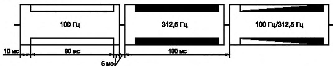
Рисунок 1 — Фрагмент структуры сигнала типа DXXXW
