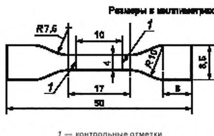
Рисунок 2 — Образец в виде двусторонней лопатки уменьшенного размера
