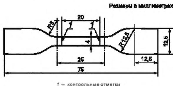
Рисунок 1 — Образец в виде двусторонней лопатки
