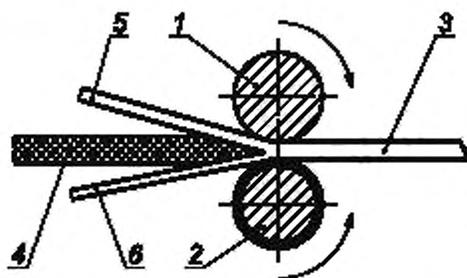
1 — ролик стальной, с проточками, 2 — ролик стальной обрезиненный; 3 — полоска, 4 — нож, стационарно закрепленный или способный перемещаться; 5 — часть полоски, из которой вырезают образцы, 6 — часть полоски, которая идет в отходы
