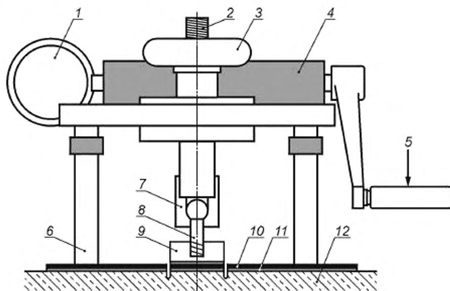
1 — манометр/индикатор силы; 2 — прижимной шпindelь; 3 — маховик; 4 — гидравлический насос; 5 — рукоятка; 6 — опоры;
