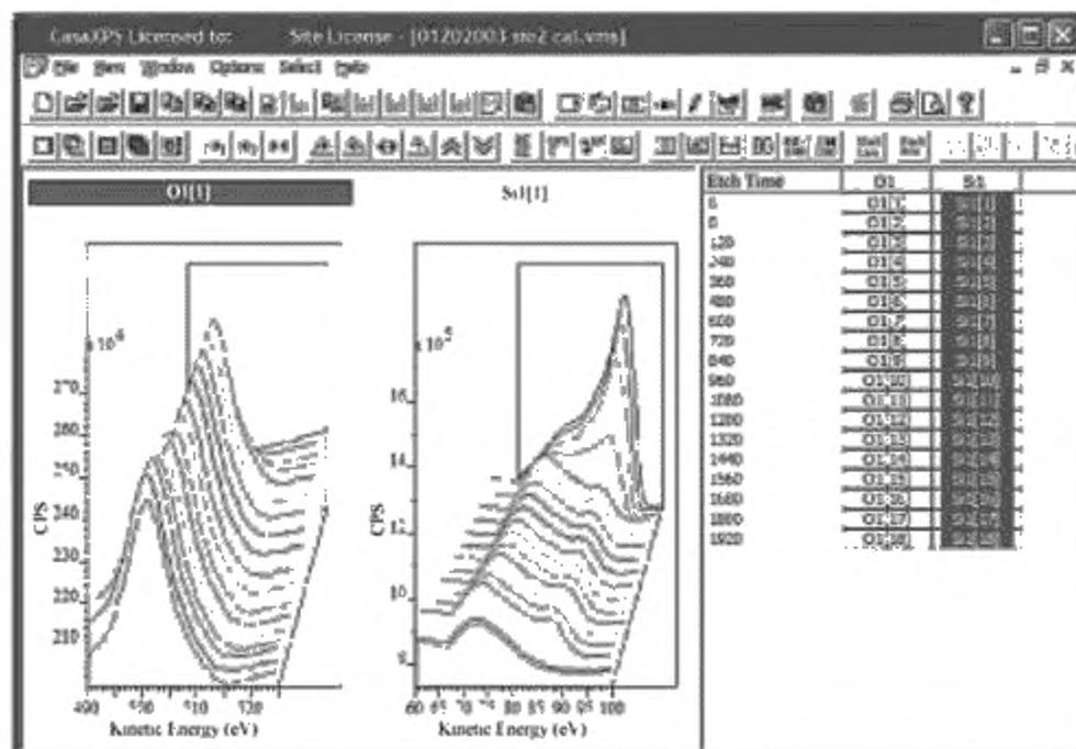
Рисунок А.6 — Монтаж спектров, показывающий профили распределения элементов по глубине, полученные с помощью ОЭС из двуоксида кремния на кремнии для кислорода (O KLL, спектры в левой части рисунка) и кремния (Si LVV, спектры в центре рисунка). Каждый спектр Оже-электронов соответствует определенному значению координаты вглубь образца, определяемому временем травления образца. Время травления указано в правой части рисунка (изображение воспроизведено из «The CASA Cookbook» [6])
