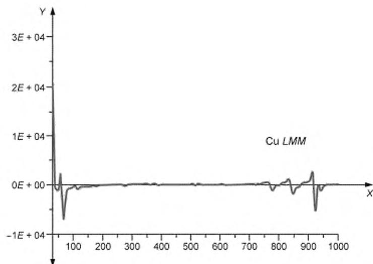
Рисунок А.4 — После распыления ионным пучком. Спектр, полученный путем дифференцирования
