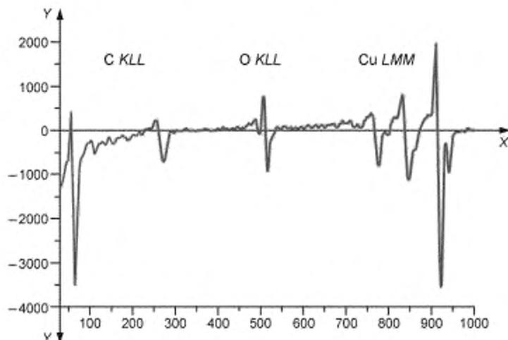
Рисунок А.2 — До распыления ионным пучком. Спектр, полученный путем дифференцирования
