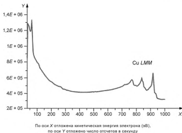
Рисунок А.3 — После распыления ионным пучком. Спектр, полученный непосредственно
