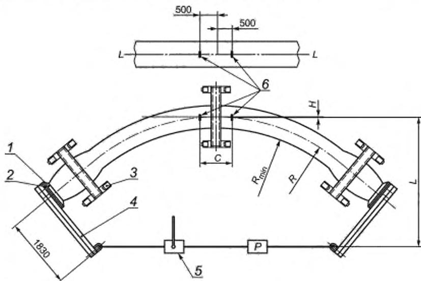
1 — фланец рукава; 2 — испытательная пластина; 3 — тележка для перемещения рукава; 4 — брус для изгиба рукава; 5 — натяжное устройство; 6 — контрольные отметки; С — хорда дуги изгиба; Н — смещение; L — плечо силы; Р — натяжение троса/значение нагрузки, регистрируемое динамометром; R — радиус изгиба рукава по центральной линии; R<sub>min</sub> — минимальный радиус изгиба
