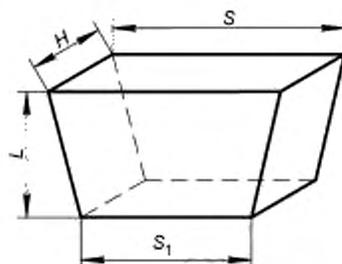
Рисунок 3 — Трапецидальный двусторонний клин номеров 6—21
