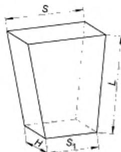
Рисунок 2 — Трапецидальный двусторонний клин номеров 3, 4
