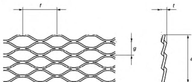
Рисунок 5.4 — Просечно-вытяжная сетка
