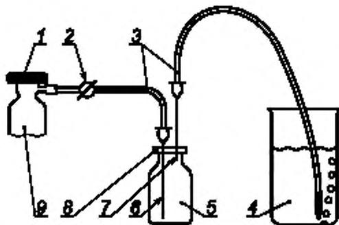
1 — клапан; 2 — второй регулирующий клапан; 3 — полихлорвиниловые трубки; 4 — стакан с водой (300 мл); 5 — сыворotka флакон (30 мл); 6 — ЭО входа иглы 1; 7 — ЭО выхода иглы 2; 8 — обжимной колпачок с PTFE перегородки; 9 — баллон с газообразным ЭО
