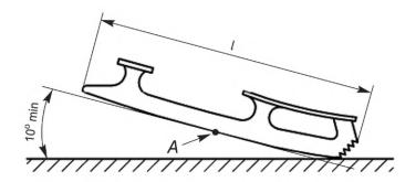
А — точка, через которую проводят касательную для измерения угла (A = 1/2l); I — длина полоза конька
