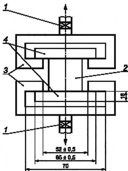
1 — карданный шарнир; 2 — образец; 3 — захваты; 4 — колодки
