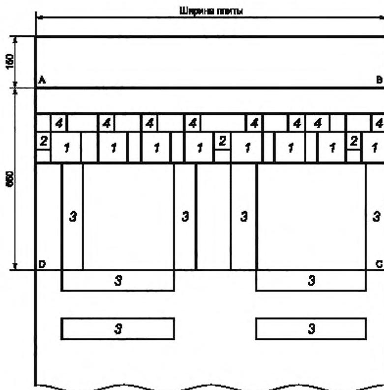
1 — образцы для определения плотности, разбухания по толщине за 24 ч и водопоглощения; 2 — образцы для определения влажности; 3 — образцы для определения предела прочности при изгибе; 4 — образцы для определения предела прочности при растяжении перпендикулярно плоскости плиты; ABCD — образец для определения отклонения от плоскостности
