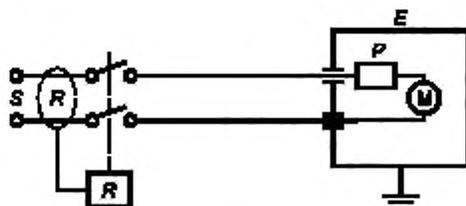
$S$  — питание;  $E$  — кожух электродвигателя;  $R$  — устройство защитного отключения ( $I_{\Delta n} = 30 \text{ mA}$ ) с автоматическим выключателем или без него;  $P$  — защитное устройство (внешнее или внутреннее);  $M$  — электродвигатель
