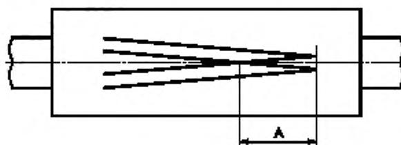
Рисунок GG.4 — Измерение амплитуды вибрации
