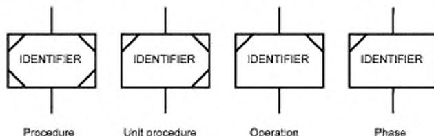
Identifier — идентификатор; procedure — процедура; unit procedure — процедура технологической установки; operation — операция; phase — фаза
