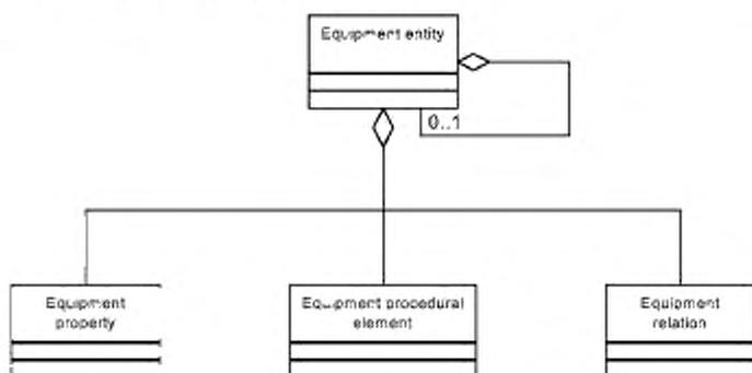
Equipment entity — сущность оборудования; equipment property — свойство оборудования; equipment procedural element — процедурный элемент оборудования; equipment relation — взаимосвязи оборудования
