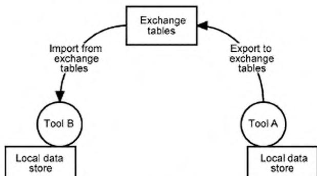
Exchange tables — таблицы обмена; import from exchange tables — импортирование из таблиц обмена; export to exchange tables — экспортирование в таблицы обмена; tool a — инструмент а; tool b — инструмент в; local data store — локальное устройство памяти для хранения данных
