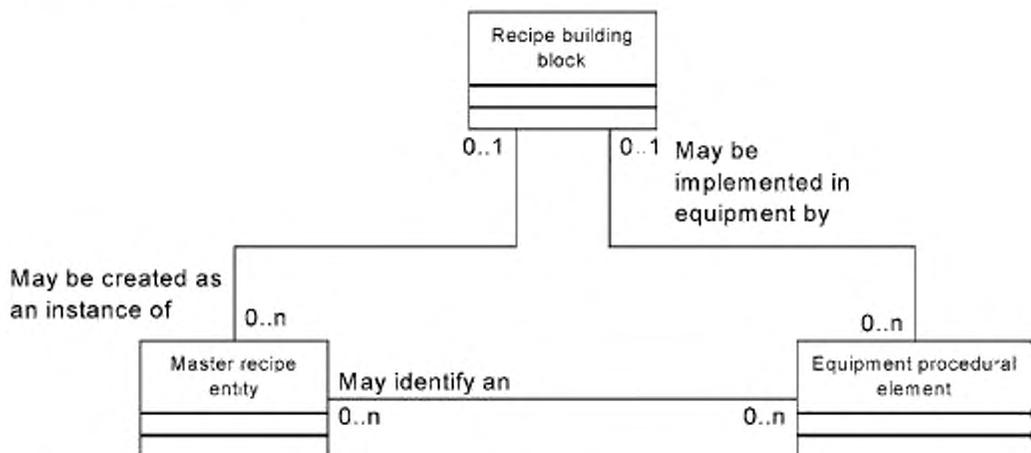
Recipe building block — структурные элементы рецептуры; may be implemented in equipment by — может быть реализовано в оборудовании с помощью; may be created as an instance of — может быть создано как реализация (экземпляр); master recipe entity — сущность технологической рецептуры; may identify an — может идентифицировать; equipment procedural element — процедурный элемент оборудования
