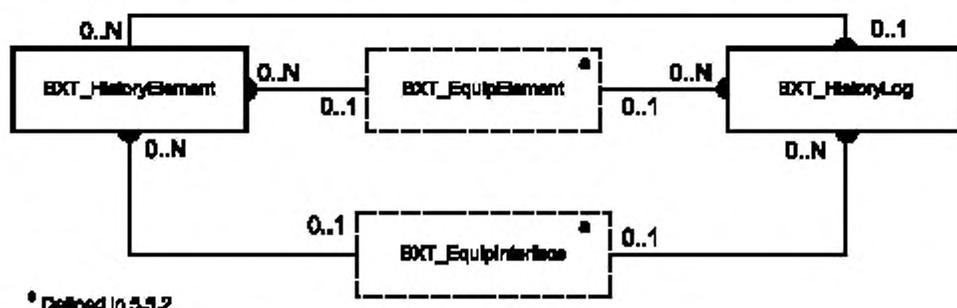
BXT\_HistoryElement — таблица элементов истории производства; BXT\_EquipElement — таблица элементов оборудования; BXT\_HistoryLog — журнал исторических событий; BXT\_EquipInterface — таблица интерфейсов оборудования
