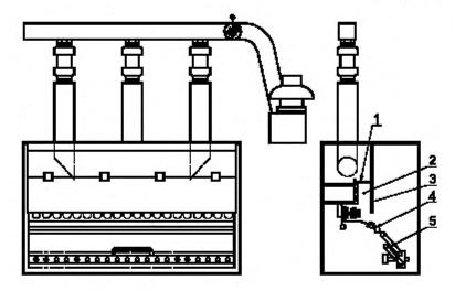
I — разделительная перегородка; 2 — внутренний канал; 3 — передняя поворотная заслонка; 4 — пепельница; 5 — механия
