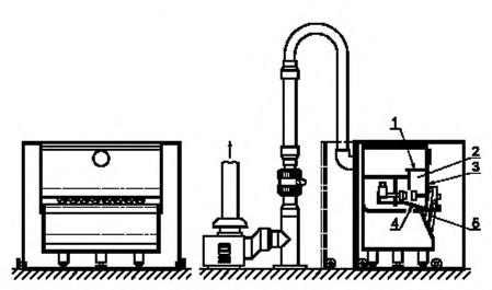
J- разделительная перегородка; 2- внутренний каная; J- передняя поворотная заслонка; d- пепельница; S- механизм зажигания
