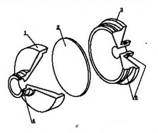
I — передняя часть держателя фильтра; 2 — фильтрующий диск; 3 — задняя часть держателя фильтра; 4 — кольцеобразное соединение; 5 — кольцеобразные соединения задней части держателя фильтра.
