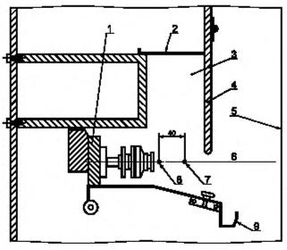
1 — панель прокурявания; 2 — разделительная перегородка; 3 — внутренний канал; 4 — передняя поворотная заслонка; 5 — передняя часть курительной машины, 6 — положение оси ситареты; 7 — стандартное положение для измерения скорости воздуха; 8 — положение устройства окончания курения; 9 — пепельница
