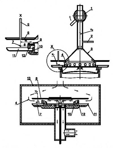
I — шаровой кран; 2 — канал для введения конда; 3 — вытяжной колпак; 4 — поток воздуха; 5 — канал для введения датчика; 6 — колпак; 7 — стандартное положение для измерения скорости воздуха; 8 — ось сигареты; 9 — перфорированный двек; 10 — кольцо устройства для прокуривания; 11 — пепельница; 12 — держатель сигарет; 13 — камера  $V_{\pi}$  — скорость воздуха вокруг сигареты,  $V_{K}$  — скорость воздуха в вытяжном канале
