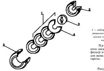
Л — лабиринтовые уплотнения; 2 — опора перфорированного диска; 3 — перфорированный диск; 4 —
