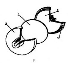
фильтрующий диск; 2 – задняя часть держателя фильтра; 3 – передняя часть держателя фильтра;
