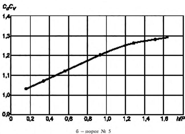
Рисунок 5 — Значения коэффициентов расхода с учетом скорости подхода для треугольных порогов с закругленным гребнем
