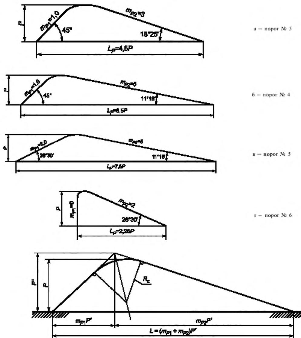
$m_{p1}$  — коэффициент верхнего откоса (число по горизонтали);  $m_{p2}$  — коэффициент низового откоса (число по горизонтали);  $L_p$  — длина продольного профиля порога по основанию;  $P$  — высота порога относительно дна канала верхнего бьефа;  $P'$  — высота остроугольного порога по радиусу закругления относительно дна канала верхнего бьефа (рисунок 2а);  $R_c$  — радиус закругления гребня порога
