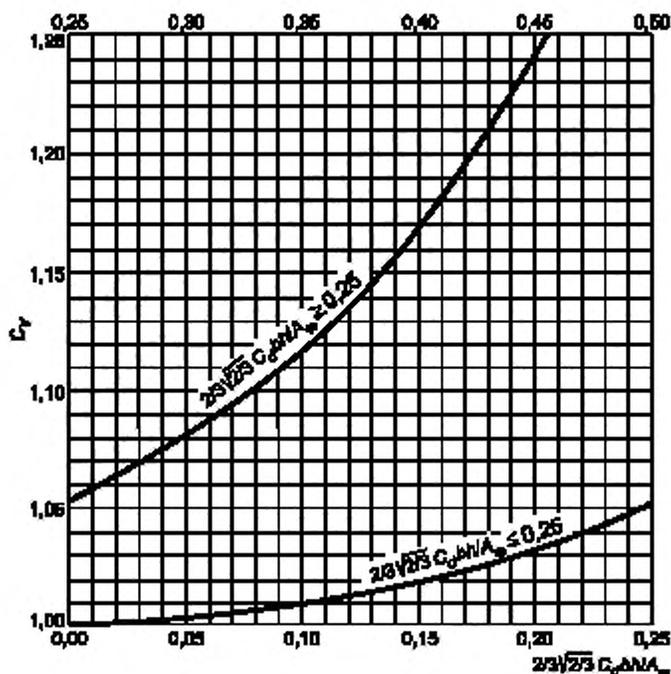
Рисунок 6 — Коэффициент скорости подхода потока  $C_V$
