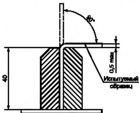
Рисунок 2 — Перегибание образца
