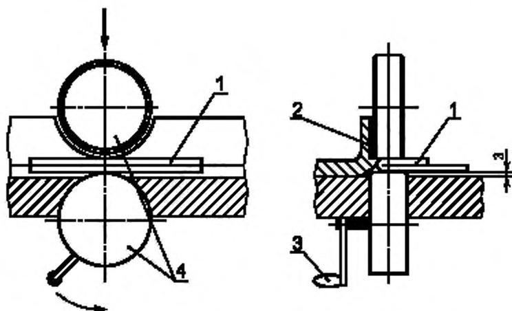
1 — испытуемый образец, 2 — стопор, 3 — рукоятка, 4 — валики
