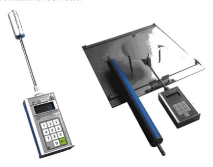
Рисунок 1 — Прибор для измерения напряженности электростатического поля СТ-01
