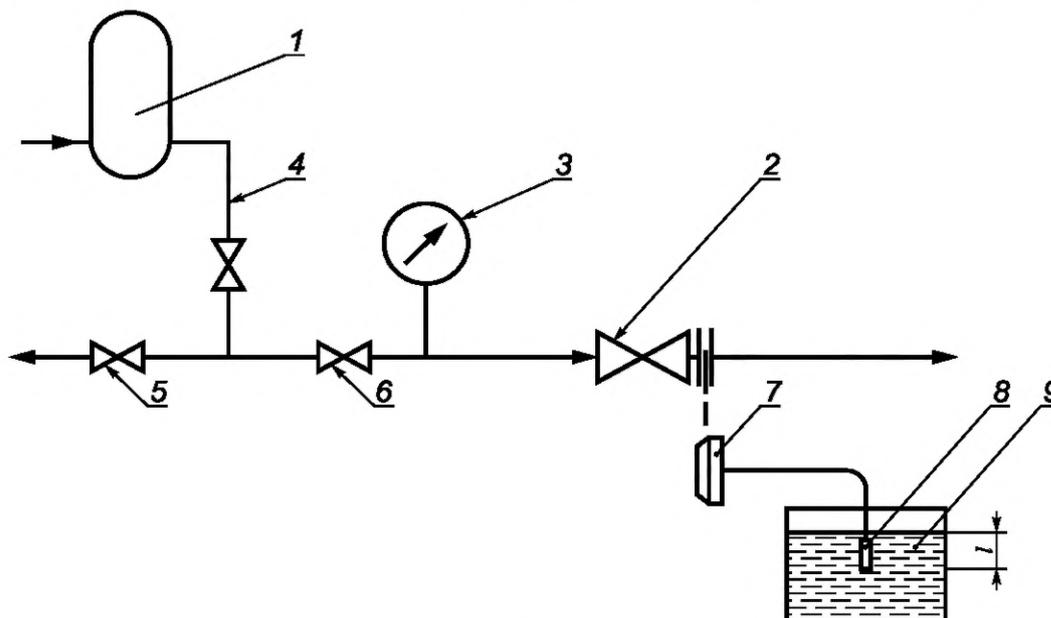
1 — источник сжатого воздуха; 2 — испытуемая ТПА; 3 — прибор для измерения давления; 4, 5, 6 — запорно-регулирующий клапан; 7 — заглушка с трубкой; 8 — насадка; 9 — емкость с водой;  $l$  — расстояние между выпускным концом насадки и поверхностью воды
