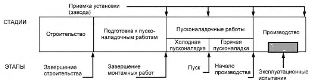
**Примечание** — Стадии «строительство» и «подготовка к пусконаладочным работам» могут перекрывать друг друга.
