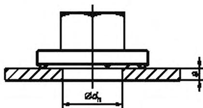
Рисунок 2 — Присоединительные размеры (гайки еще не приварены)
