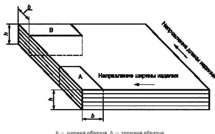
Рисунок 4 — Схема формирования (вырезания) образцов
