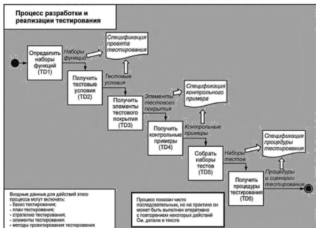
Рисунок 10 — Процесс Разработки и Реализации Тестирования
