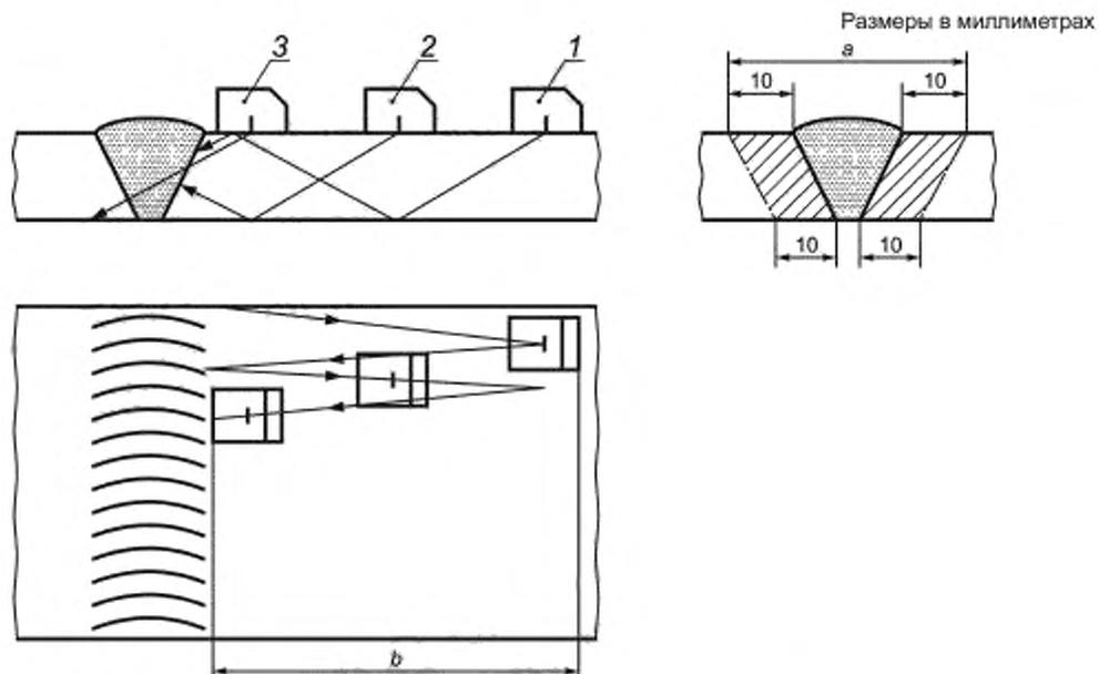
1 — положение 1, 2 — положение 2; 3 — положение 3, а — ширина зоны контроля; b — ширина зоны сканирования
