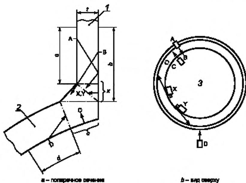
1 — деталь 1 (штуцер); 2 — деталь 2 (корпус); 3 — прямой преобразователь; A, B, C, D, X, Y — схема контроля;
