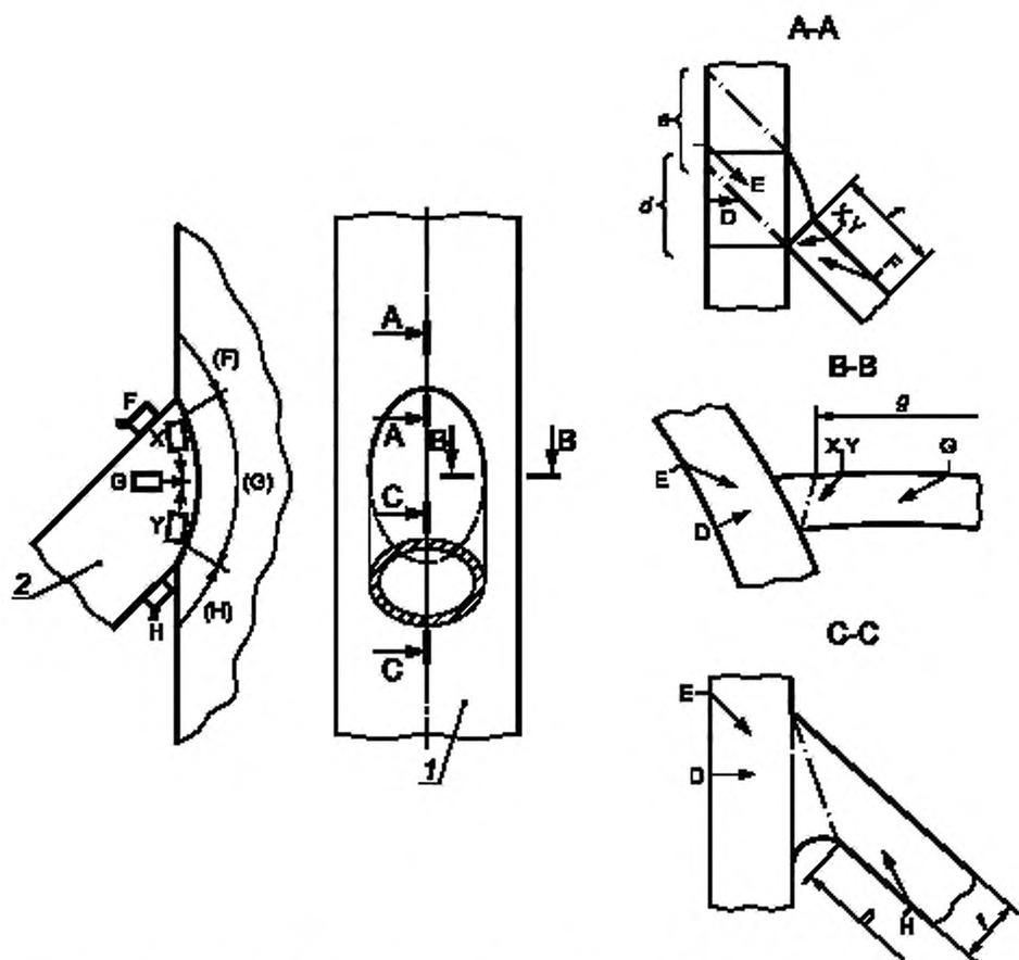
1 — деталь 1 (основная труба), 2 — детали 2 (отводная труба); A, B, C, D, E, F, G, H, X, Y — схема контроля,
