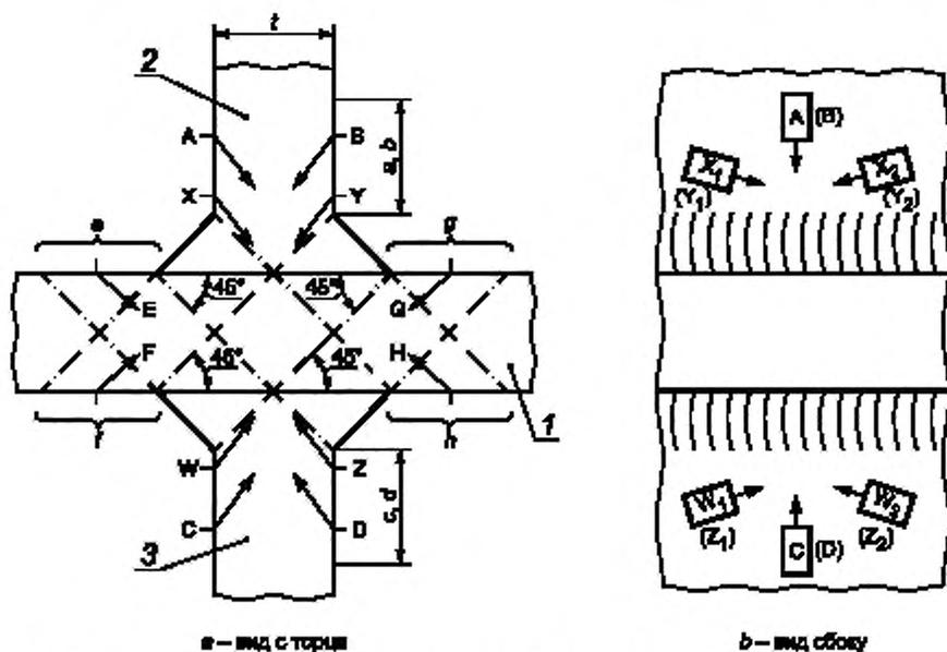
1 — деталь 1, 2 — деталь 2, 3 — деталь 3; A, B, C, D, E, F, G, H, W, X, Y, Z, Z<sub>1</sub>, Z<sub>2</sub> — схема контроля;
