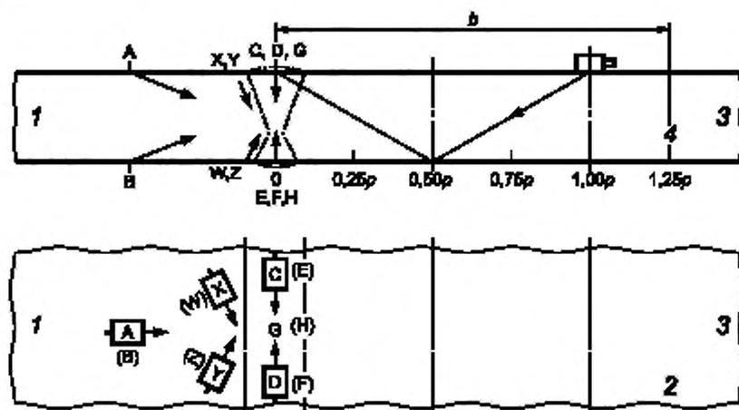
1 — деталь 1, 2 — вид сверху; 3 — деталь 2; 4 — вид сбоку; А, В, С, D, E, F, G, H, W, X, Y, Z — схема контроля;  $b$  — ширина зоны сканирования (SZW), зависящая от  $p$  ( $p$  — проекция пути однократно отраженного луча)
