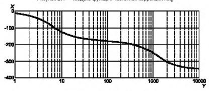
Х -- фазочастотная характеристика, У -- частота, Гц
