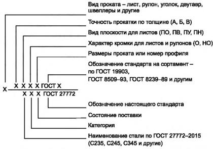
Прокат горячекатаный листовой повышенной точности (A), высокой плоскостности (ПВ), с обрезной кромкой (O), размерами (10×1000×2000) мм по ГОСТ 19903, из стали С390, в улучшенном состоянии (У), категории 6:
