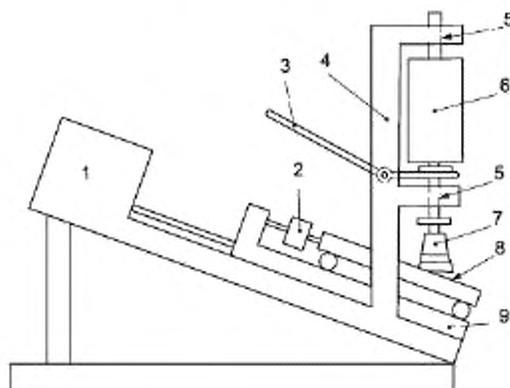
1 — тяговый механизм; 2 — датчик нагрузки; 3 — рычаг для подъема наконечника во время обратного движения;
