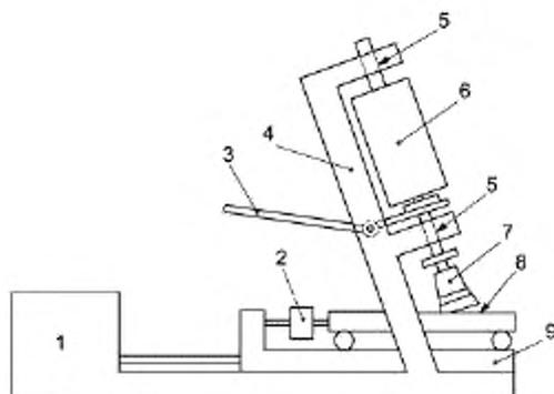
1 — тяговый механизм; 2 — датчик нагрузки; 3 — рычаг для подъема наконечника во время обратного движения;
