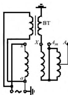
Рисунок ДА.3.4 — Испытание однофазного автотрансформатора с подпорным напряжением в нейтрали
