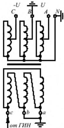
Рисунок ДА.2.4 — Пофазное испытание изоляции относительно земли (а) и испытание изоляции между фазами (б) трехфазного трансформатора с пятистержневым магнитопроводом и замкнутой в треугольник обмоткой НН
