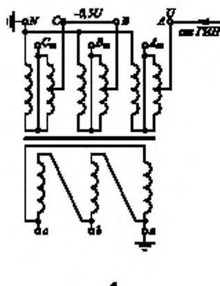
Рисунок ДА.2.6 — Пофазное испытание трехобмоточного автотрансформатора
