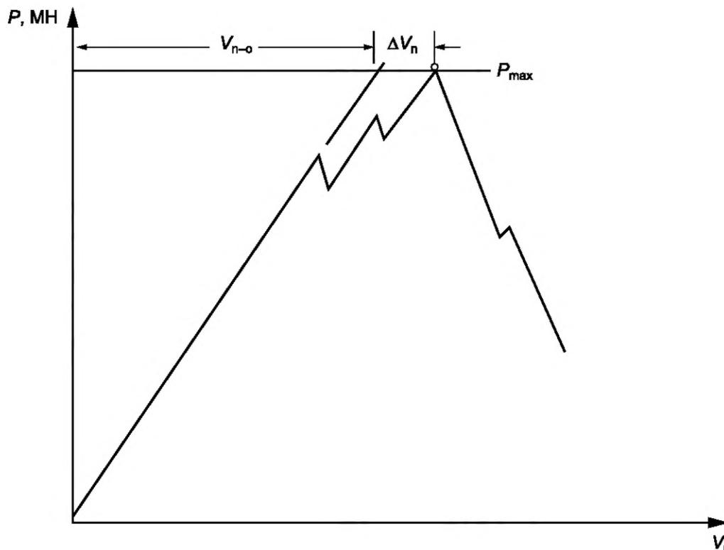
$P$  — нагрузка;  $V_{n-o}$  — значение смещения берегов трещины на начальном линейном участке;  $\Delta V_n$  — дополнительное значение смещения берегов трещины на участке диаграммы между линейным участком и максимальной нагрузкой;  $P_{max}$  — максимальная нагрузка
