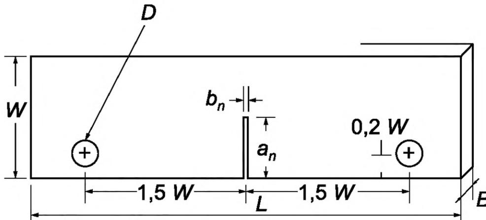
$D$  — диаметр отверстия для крепления;  $W$  — ширина образца;  $b_n$  — ширина предварительно нанесенной усталостной трещины (надреза);  $a_n$  — длина предварительно нанесенной усталостной трещины (надреза);  $L$  — длина образца;  $B$  — толщина образца
