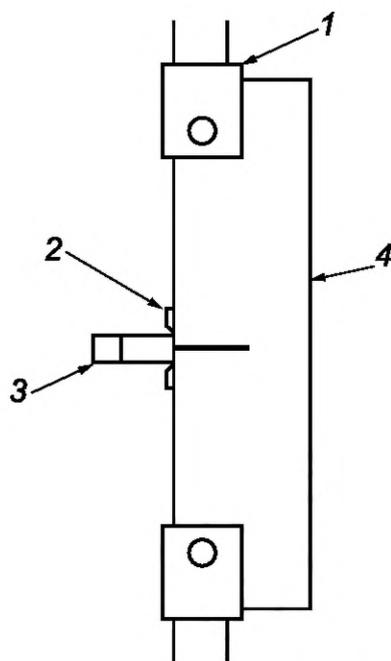
1 — захват испытательной машины; 2 — накладные клиновидные опорные призмы;
