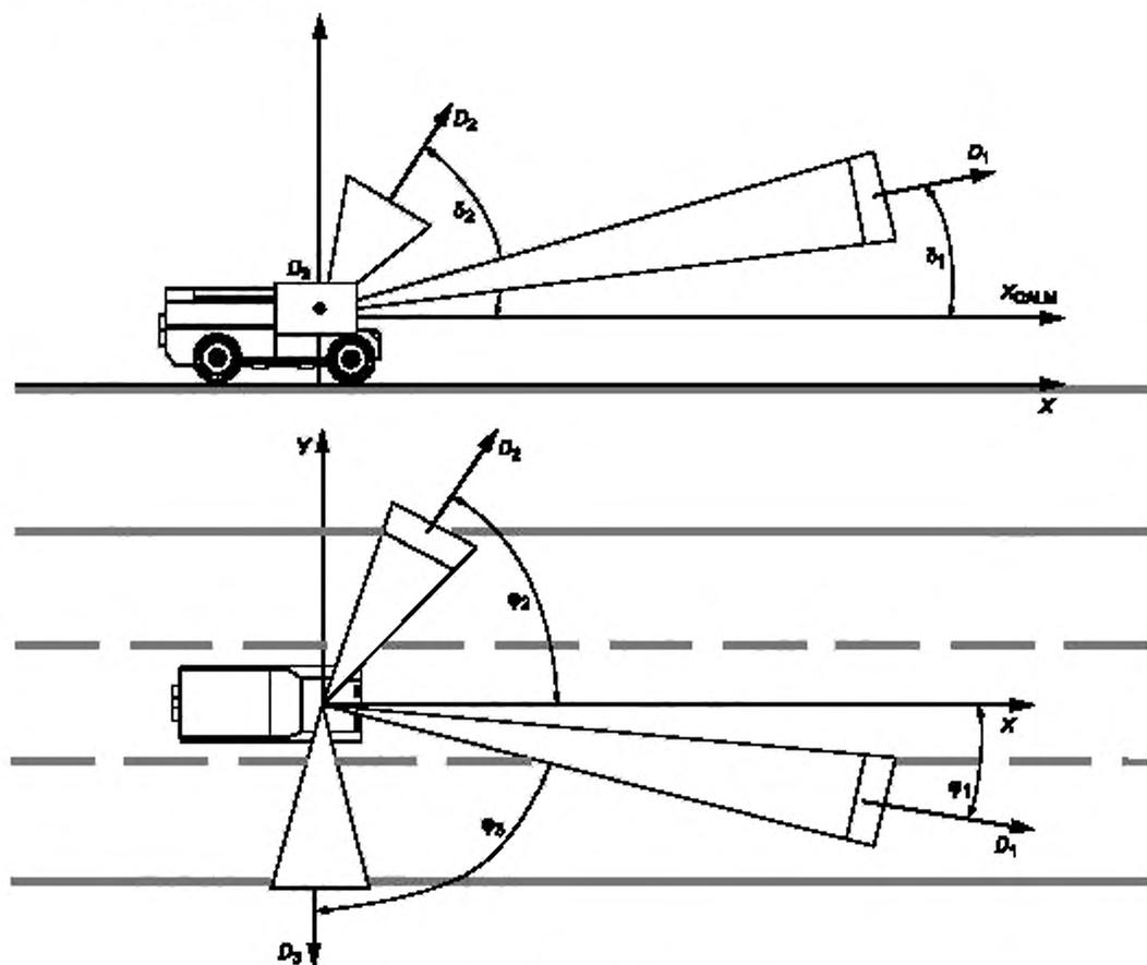
Рисунок D.1 — Многолучевая антенна
