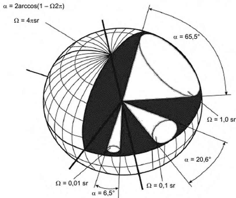
Рисунок 1 — Телесный угол
