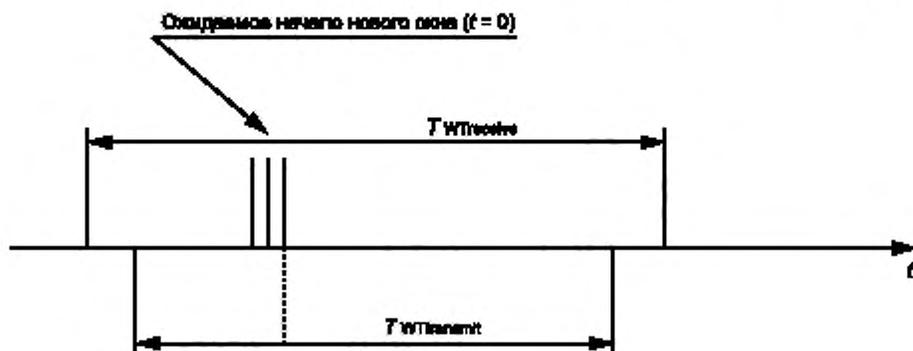
Рисунок 8 — Окно синхронизации (W-Sync) приемника и окна передатчика
