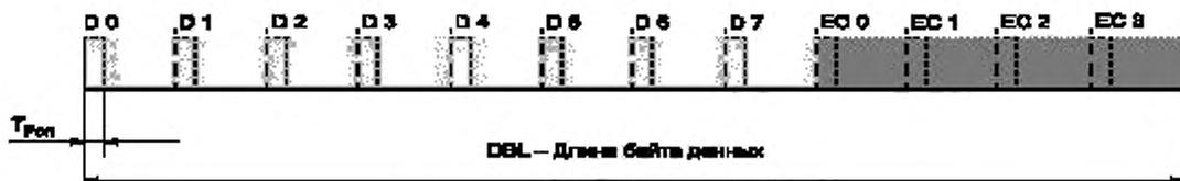
Рисунок 3 — Модуляция профилей 0 и 1
