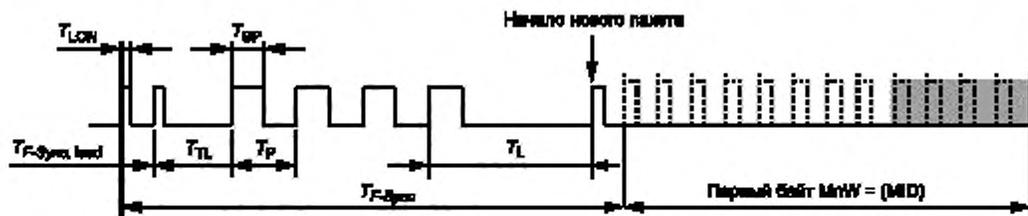
Рисунок 7 — Сигнал синхронизации пакета (F-Sync)
