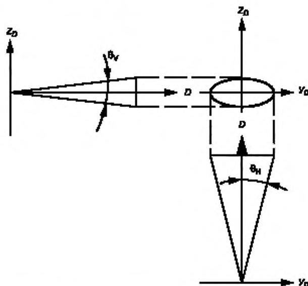
Рисунок 5 — Открытые горизонтальный и вертикальный углы
