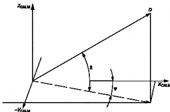
Рисунок 4 — Азимут и угол оси пучка
